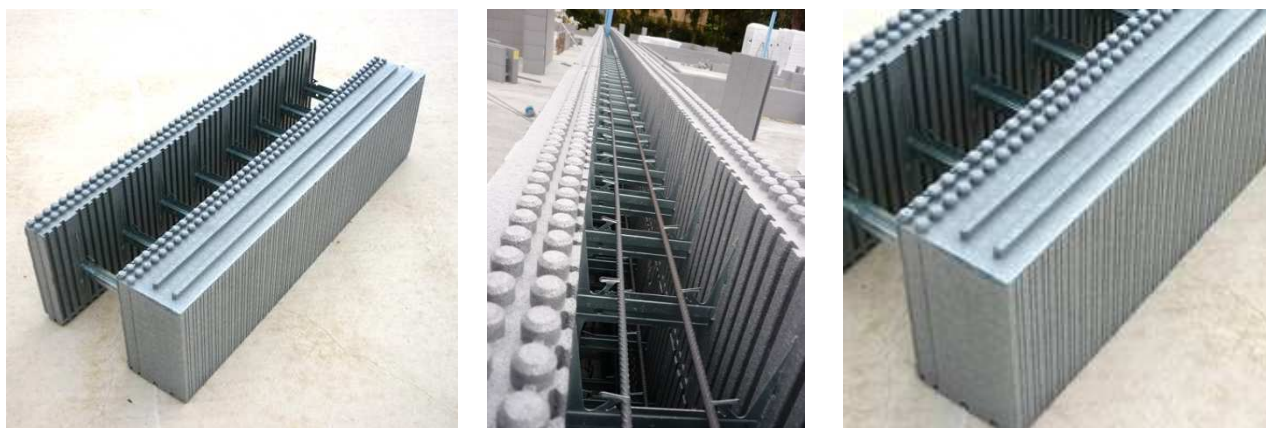
Immagini dell'Elemento. Base Argisol con il particolare della coda di rondine interna interna al cassetta a contatto con il calcestruzzo e delle scanalature esterne per l'aggrappo della finitura.
